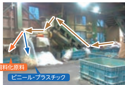
包装品の状態でコンベア輸送し、袋破後、ビニール・プラスチック(右)と飼料化原料(左)に分別
