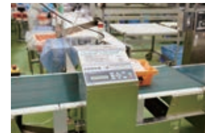
出荷の際に金属探知機に通される牛肉(東京工場)
