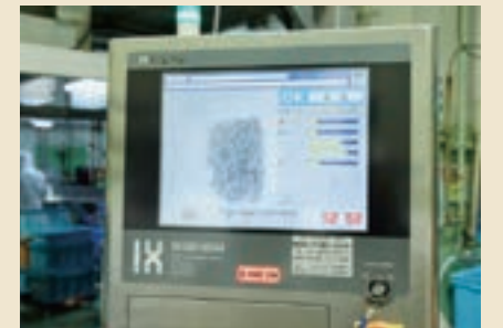
玉ねぎの梱包ラインで使用するX線異物検出機
