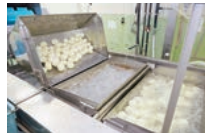
何層にも渡って洗浄と殺菌を繰り返し異物を除去する(東京工場)
