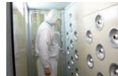
製造ラインに立ち入る際には、エアシャワーと静電気の力を利用して微量の付着物を取り除く簾を通過する(東京工場)
