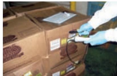
入荷された食材の温度を測定して基準内であることを確認(東京工場)
