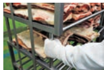
フレームの握り部分を円筒形にすることで、つかみやすく、洗浄しやすいなど安全衛生面での工夫が施されている
