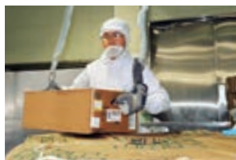
腰痛予防のため(株)吉野家ホールディングスの東京工場に導入された「ラクラクハンド」。30kgまでの持ち上げを補助できる
