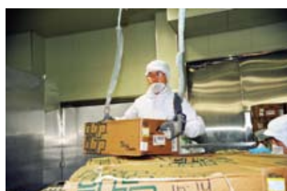
腰痛予防のために導入された「ラクラクハンド」。30kgまでの持ち上げを補助できる
