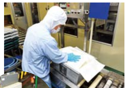
人の手で蓋をして金属探知機を通過後、出荷されます。
