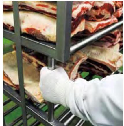
フレームの握り部分を円筒形にすることで、つかみやすく、洗浄しやすいなど安全衛生面での工夫が施されている
