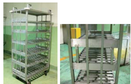
フレームの内側に持つための専用部分を作り、挟まれ防止を図るなど、安全面での工夫が施されている
